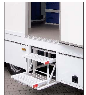
Chowane do luku schody z rozkładanym stopniem
