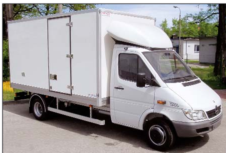
Estetyczna i lekka izoterma na Sprinterze 616, ładowność samochodu ponad 3 t
